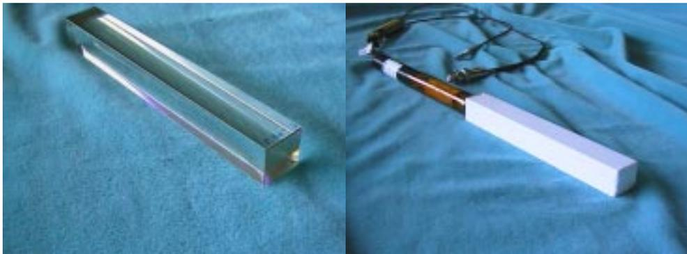
Abb. 2.9 Ansicht eines Bleiwolframat-Kristalls, vor und nach der Ankopplung an einen Photomultiplier mit Spannungsteiler.
