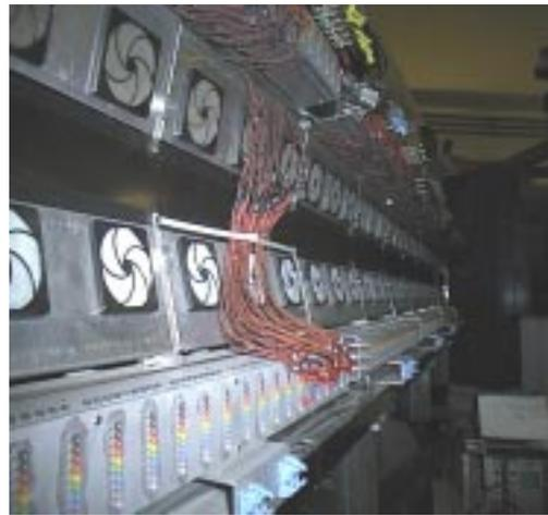
Abb. 2.5 Ansicht der Rückseite der Tagger-Detektoren. Die Mittelachse entspricht der Fokalebene
