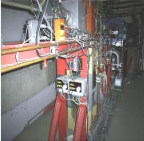
Abb. 2.4 Verlauf der Führung des Elektronenstrahls in einem Vakuumrohr bis zum Bremsstrahltarget.
